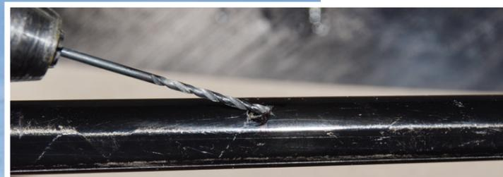
Die Bohrung für den Höhenruder-Bowdenzug muss flach erfolgen.
