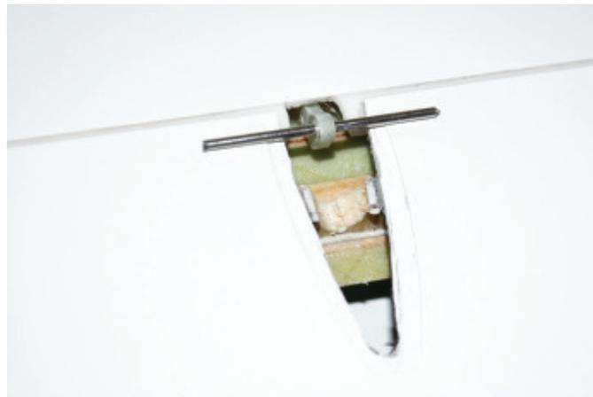
... danach klebt man das Ruderhorn ein und richtet es per Stahldraht aus.
