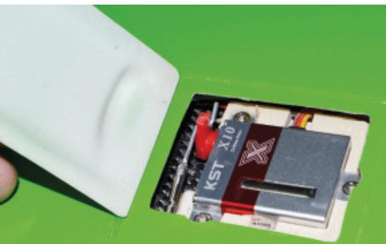
Das Wölbklappenservo ist auf diesem Bild fertig eingeklebt und angelenkt. Jetzt kommt noch die Abdeckung drauf.
